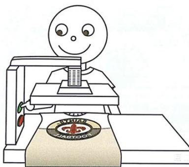
5. 設定溫度為170°C到204°C之間。啟動機器，降下熱壓板面。
